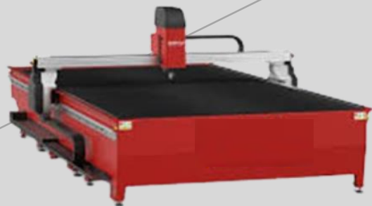
CORTADOR CNC LASER Y CNC PLASMA CAPACIDAD CORTE 30 mm
