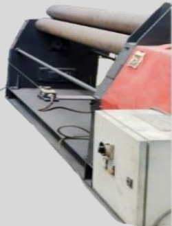
ROLADORA 3 m, espesor 8 mm
